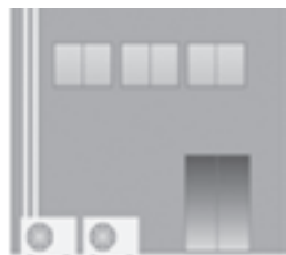
× 空調室外機や配管の露出
