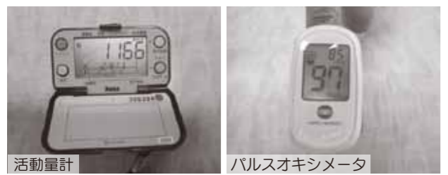
活動量計 ▲消費カロリーや歩数、運動強度などを測定するもので、健康管理に役立ちます。 パルスオキシメータ ▲血液内の酸素の飽和濃度を測定する器具。指先に簡単に測定することができ、肺疾患の重症化の徴候を察知することができます。
